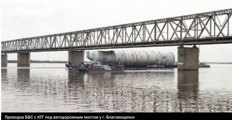
Проводка ББС с КТГ под автодорожным мостом у г. Благовещенск
